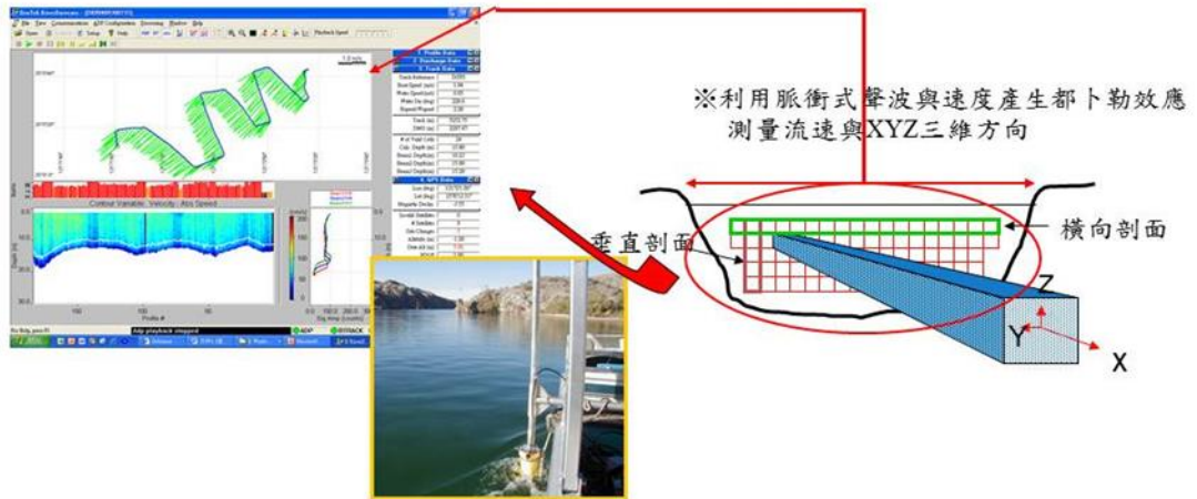
圖 4-37 海流空間掃測原理
