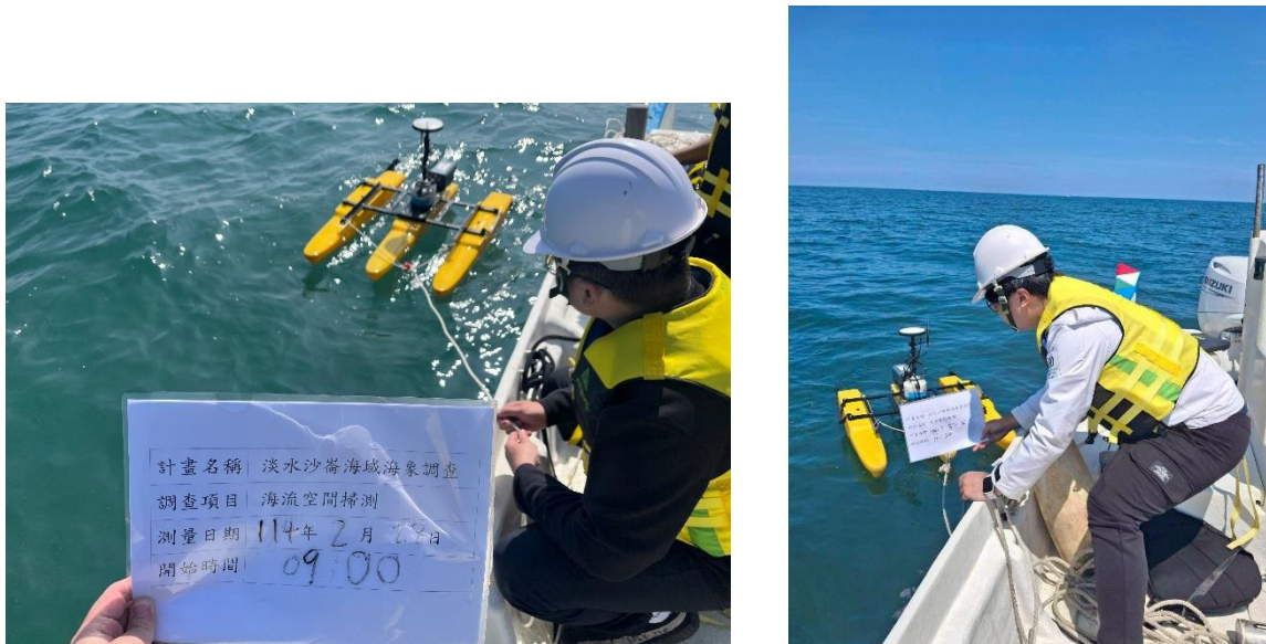
圖 4-39 船拖曳式 ADCP 現場作業
